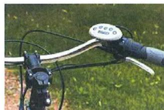
Kleines Cockpit am Lenker: Hier kann der Pedelec-Pilot die Motorleistung einstellen und sich über den Batteriestand informieren.
